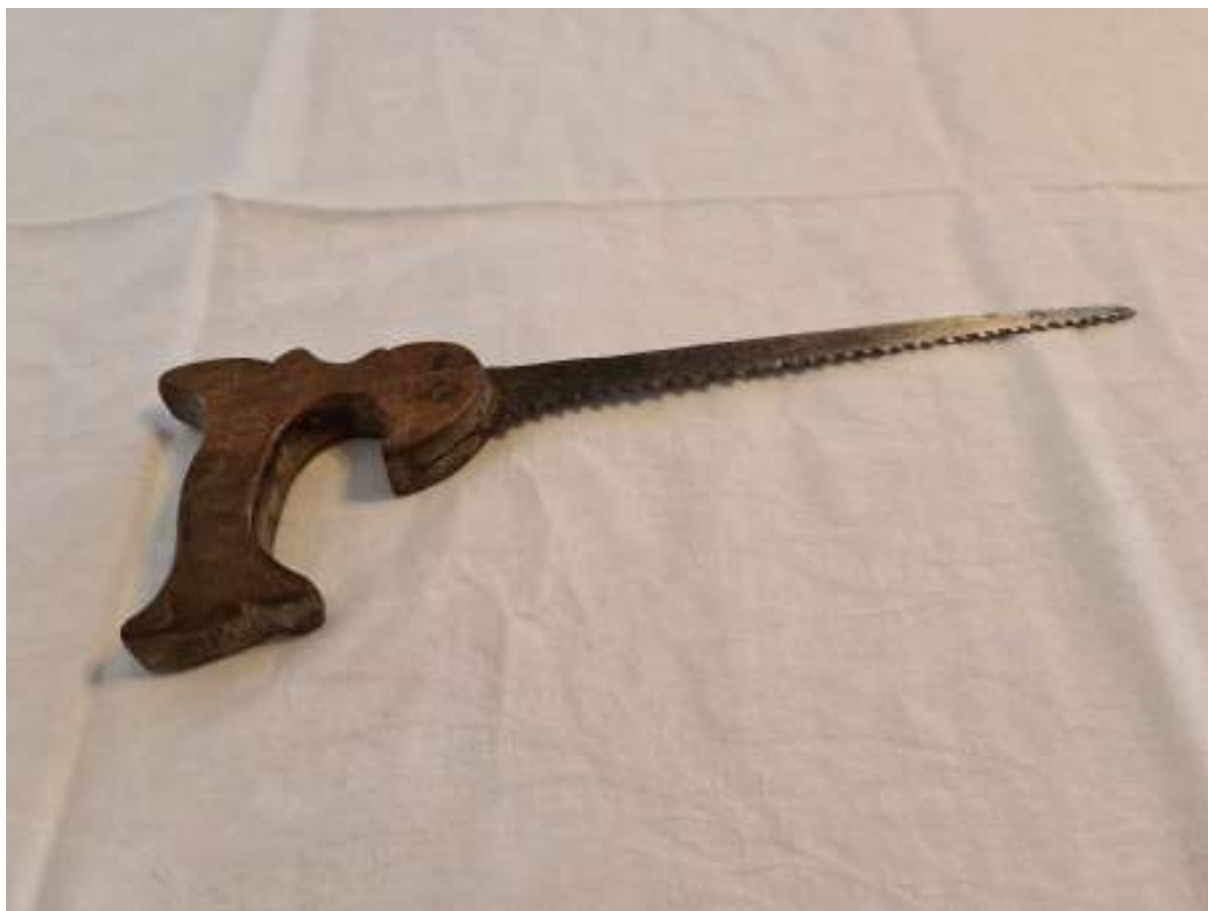
Fotografija 1: Žaga za izžagovanje odprtin in utorov v deskah iz okoli leta 1910, žaga je bila od mojega pradedka.
