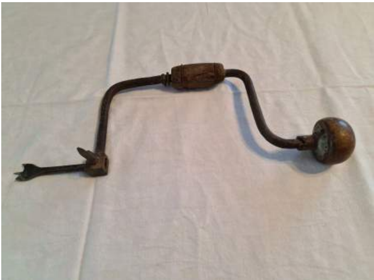
Fotografija 3: Ročni vrtalnik za vrtanje različnih lukenj v les iz konca 19. stoletja, vrtalnik je bil od mojega pra pra dedka.
